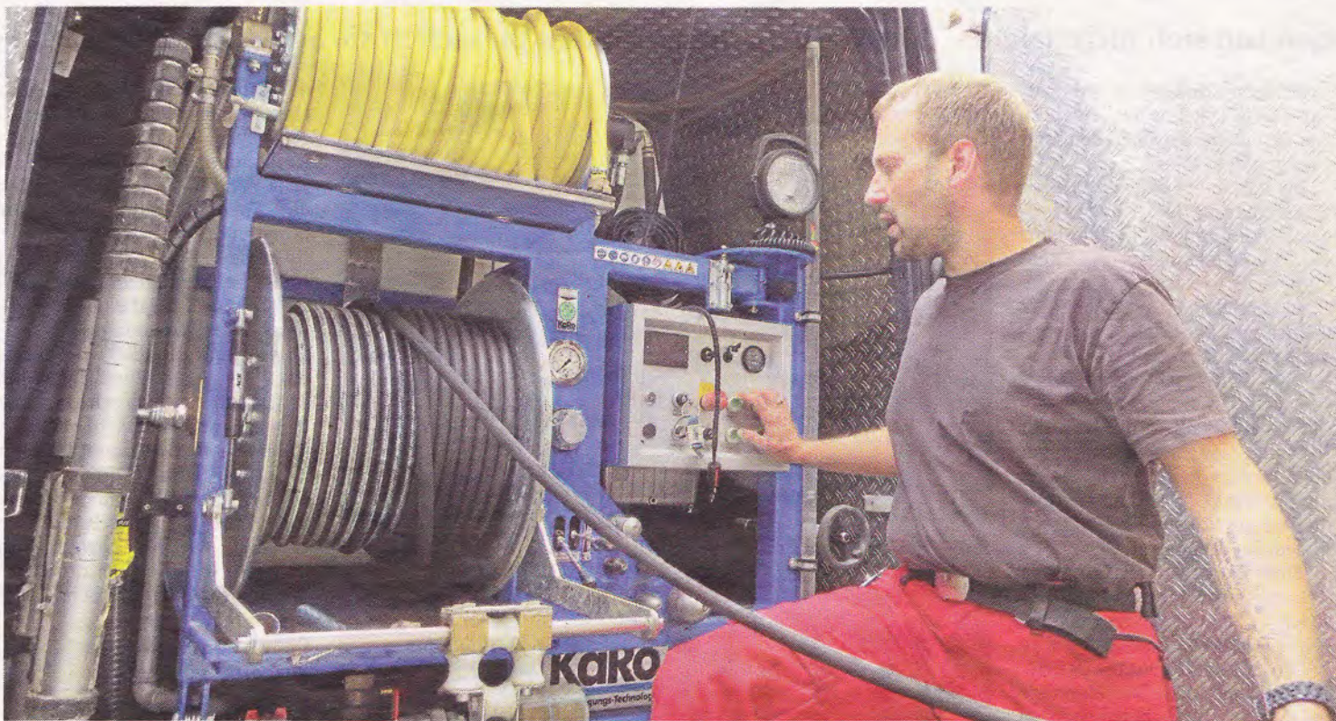
Mit diesen Schläuchen reinigt Jens Stamm Rohre und Kanäle.
